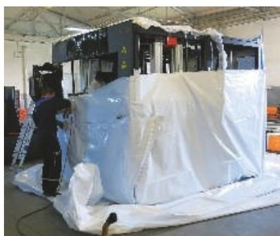
**INTERCEPT TECHNOLOGY** dispone de una solución de embalaje, con protección UV, y que mediante retráctilado, permite el almacenaje y protección de vehículos y sistemas de armas tanto en exteriores como en cubiertas de buques.
