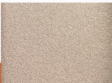
Zeolita producida sintéticamente, tiene una estructura cristalina regular y un diámetro uniforme del poro.
