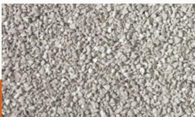
Es un producto natural de estructura molecular estratificada. Su capacidad de adsorción aumenta a mayor humedad relativa. Actúa de forma muy rápida.
